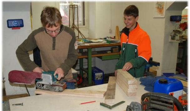
Danach wurden die Hocker mit fingerdicken Löchern versehen, um diese leichter transportieren zu können. Die Kanten wurden gebrochen und die Sitzfläche wurde mit einem Bandschleifer plangeschliffen. Der letzte Arbeitsschritt bestand in der Lackierung mit Bienenwachs. Bienenwachs sorgt für einen angenehmen Geruch und färbt die Werkstücke etwas dunkler.
